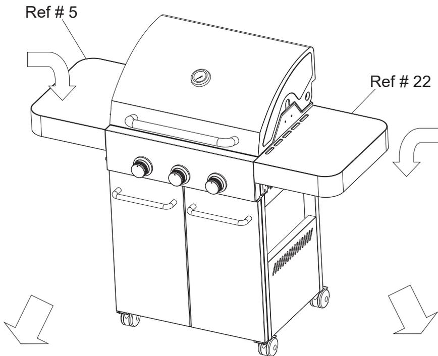
**Häng sidoborden på de förmonterade skruvarna. Spänn sedan skruvarna med en skruvmejsel**
