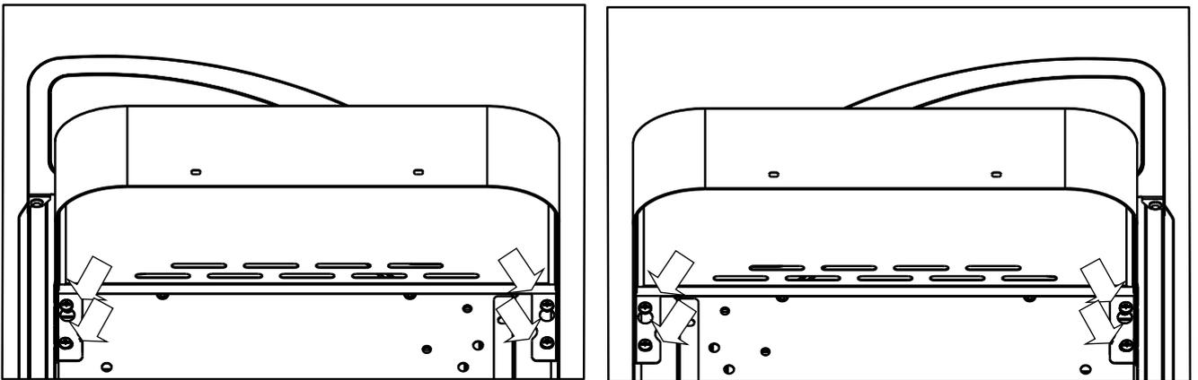
**Skruva av muttern från munstycket. Sätt in munstycket genom hålet i konsolen och skruva sedan fast muttern enligt bild.**
