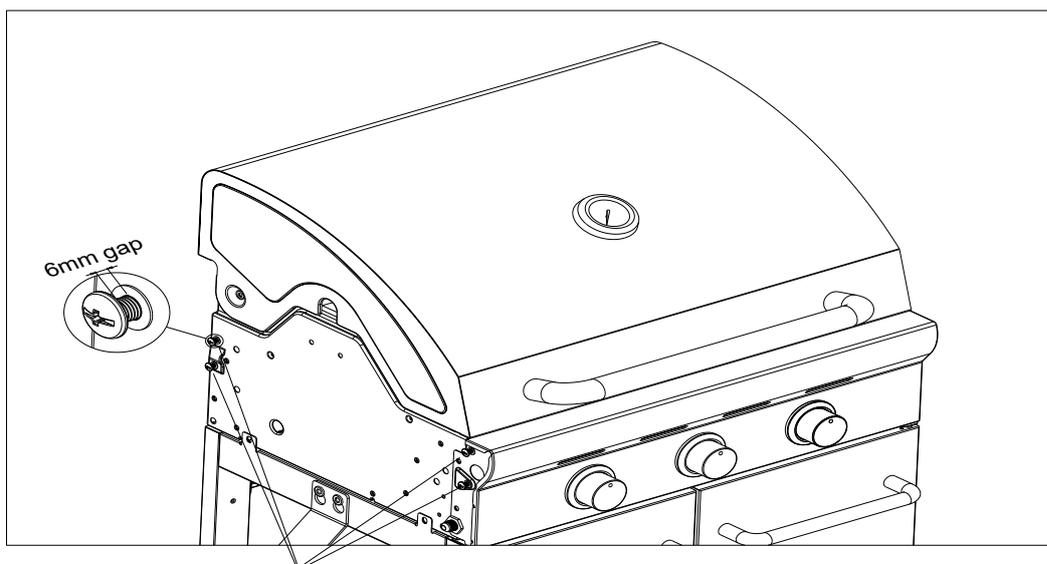
**Skruva loss de förmonterade skruvarna på båda sidorna med ett 6mm gap enligt bild.**
